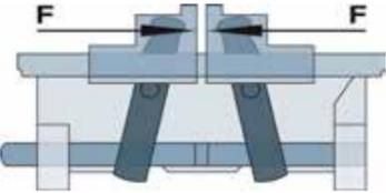
Durch die «hemo»-Kraftübersetzung lässt sich jedes Werkstück über die ganze Aufspannlänge mit korrekter Krafteinwirkung felsenfest spannen.
